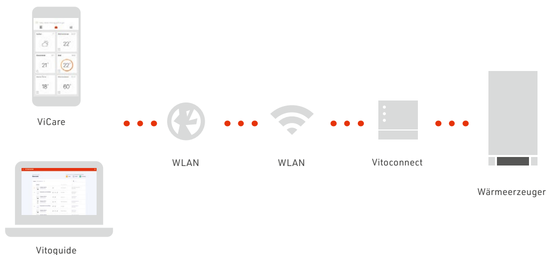
[ABB. 2] Beispiel eines integrierten Systems: Heizungssteuerung für zentrale Absenkung (Quelle: Viessmann).
