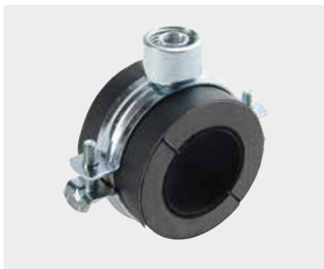
Bild 8.28: Gedämmte Rohrhalterung für eine Kälteleitung. Sie vermeidet Kältebrücken und Kondensatbildung.
