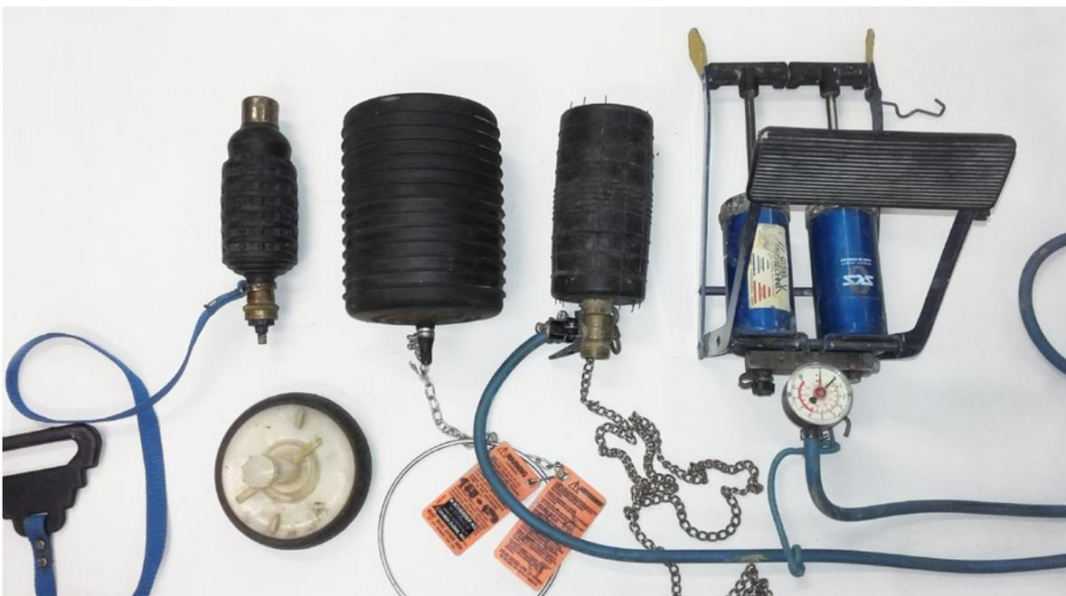
Abb. 1: Geräte für Dichtheitsprüfung mit Wasser oder Luftdruck
