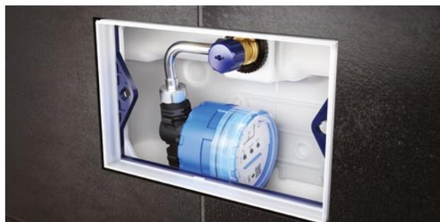
Geberit Hygienespülung Rapid: Eignet sich für den temporären Einbau zur Sicherstellung der Trinkwassererneuerung (alle 72 Stunden) bis zum bestimmungsgemässen Betrieb der Anlage. Die kompakte Abmessung sowie der Batteriebetrieb ermöglichen einen nachträglichen Einbau.
