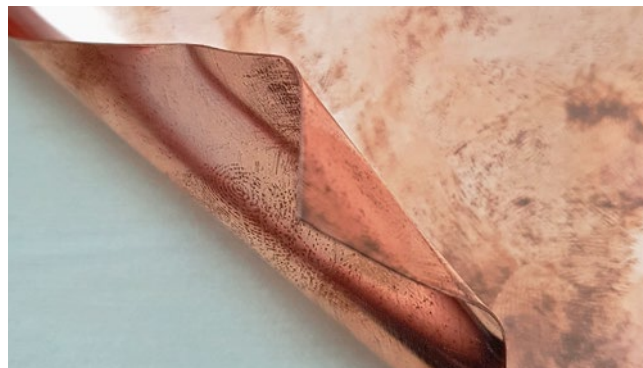
[ABB. 5] Leicht modellierbares Kupferblech 0,3 mm dick, zum Anformen.
