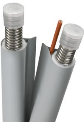
[FIG. 32] Tuyaux compacts avec isolation en aérogel. (Photo : Agitec)
