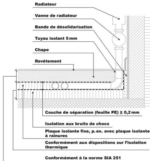
Pose de conduites de chauffage (au niveau de l'isolation thermique); disposition en forme d'étoile; avec isolation contre les bruits de chocs.
