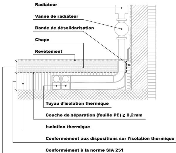
Pose de conduites de chauffage (au niveau de l'isolation thermique); disposition en forme d'étoile; sans isolation contre les bruits de chocs.
