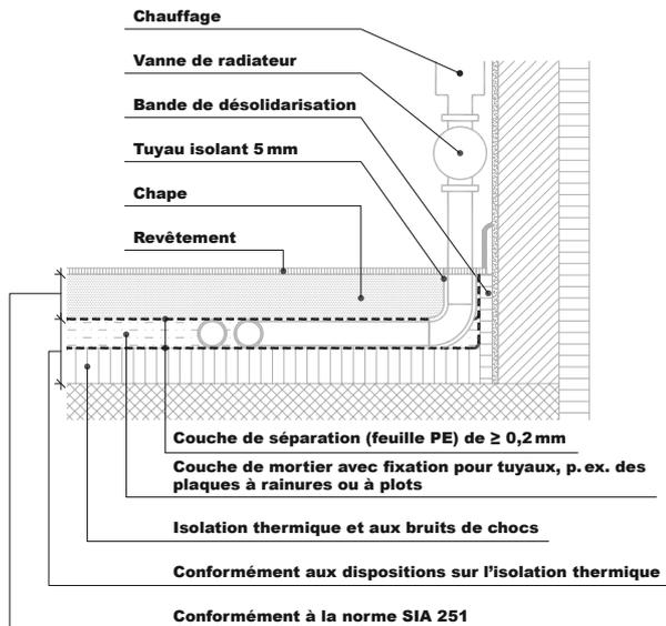
Pose de conduites de chauffage (intégrées dans la couche de mortier); disposition en forme d'étoile; avec isolation contre les bruits de chocs.
