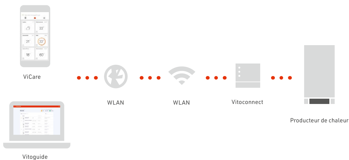
[FIG. 2] Exemple d'un système intégré : commande de chauffage pour un abaissement de température centralisé (source : Viessmann).
