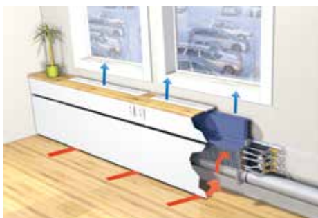
Illustration 6.6: Les convecteurs de climatisation sans ventilateur (appareils à induction) fonctionnent silencieusement. (Source: Swegon)
