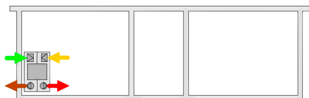
[FIG. 4] Ventilation par local.
