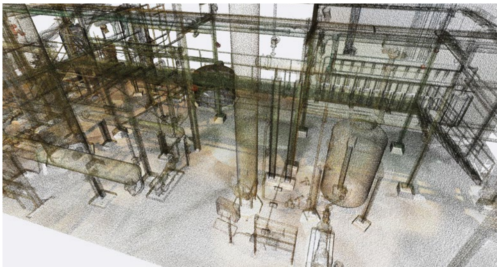
[FIG. 3] Nuage de points. (Source de l'image : Leica Geosystems)
