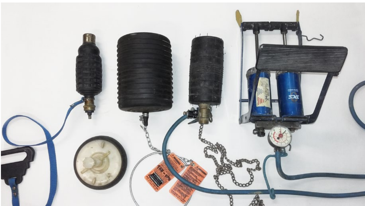
Ill. 1 : Appareils pour essai d'étanchéité avec de l'eau ou de l'air
