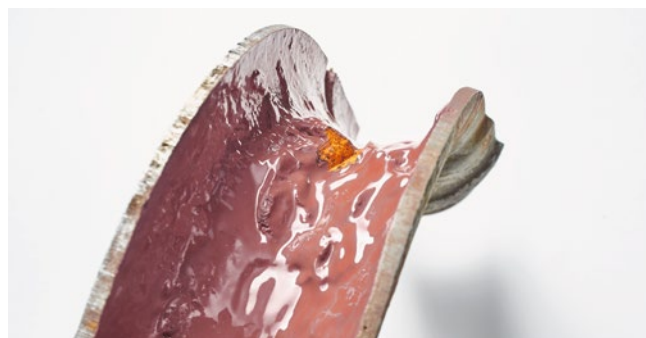
[FIG. 5] Problème de nettoyage et d'adhérence sur le côté intérieur du coude.
