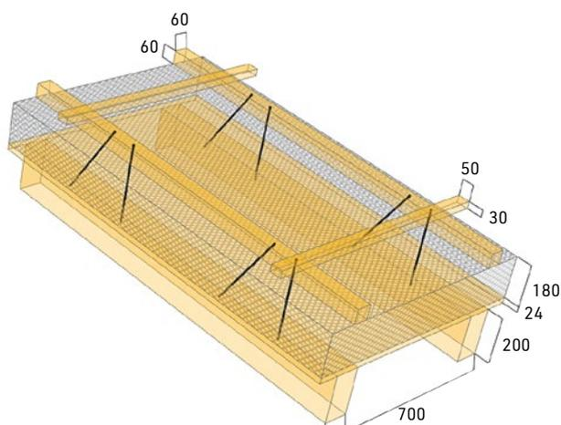
[FIG. 10] Documentation du fournisseur sur le dimensionnement des vis.
