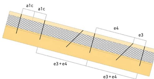
[FIG. 11] Les logiciels HECO®-HCS ou Profix permettent de calculer les écarts entre les vis pour la fixation des contre-lattes.
