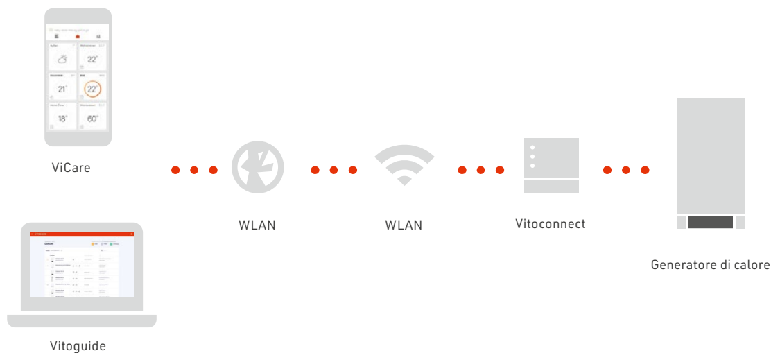
[FIG. 2] Esempio di un sistema integrato: comando dell'impianto di riscaldamento per un abbassamento centralizzato della temperatura (fonte: Viessmann).
