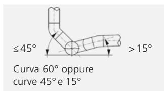
Fig. 3: I raccordi laterali o le condotte laterali di collettori di fondo e di allacciamento spostati in altezza vanno eseguiti, se possibile, con deviazioni rispettivamente piegature a gomito sul collettore di fondo di transito.
