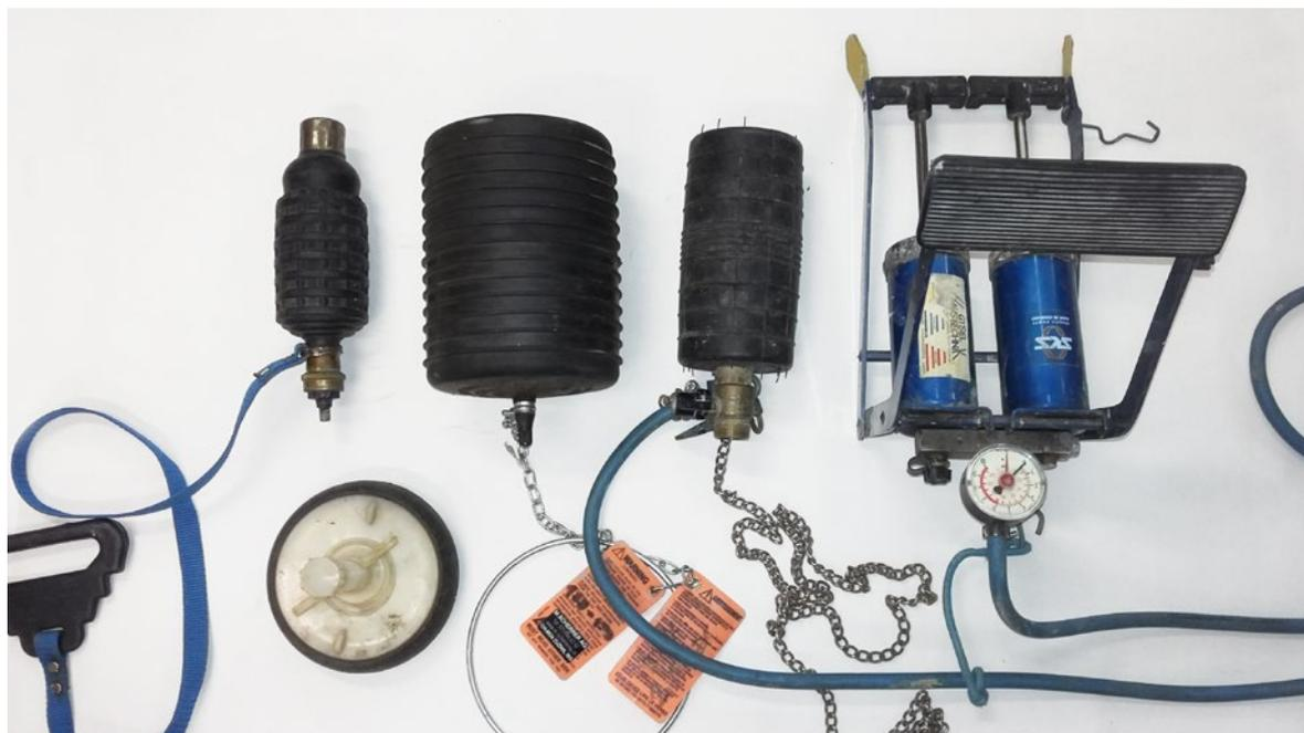
Fig. 1: Apparecchi per la prova di tenuta stagna con acqua o aria compressa
