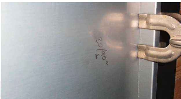
Le prescrizioni per il collaudo della resistenza alla grandine esigono cinque «spari», senza danno ottico visibile.
