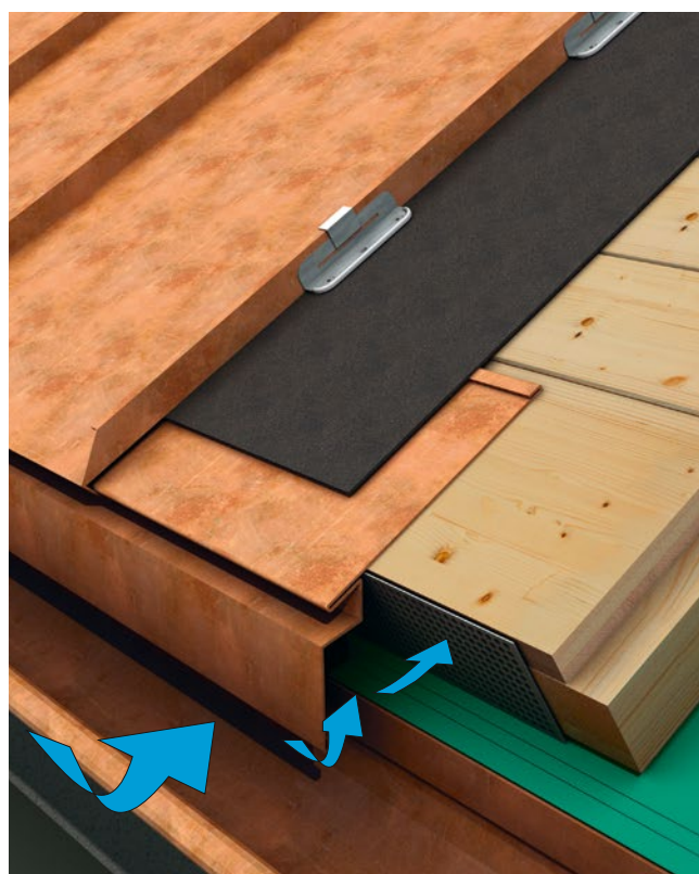
[FIG. 5] Costruzioni a ventilazione indiretta con assito chiuso di perline (giunti a scanalatura e linguetta) e la scelta del giusto interasse riducono essenzialmente i rumori di svolazzamento indesiderati.
