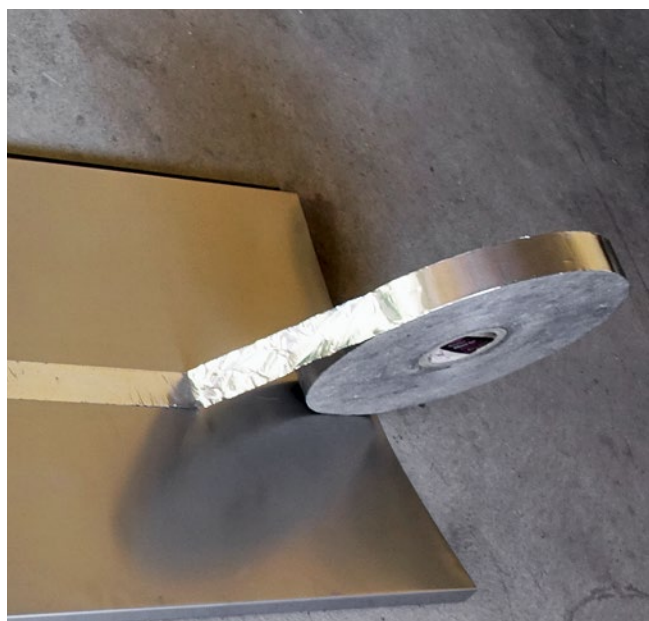
[FIG. 6] Telo fonoassorbente sul retro del nastro di lamiera.
