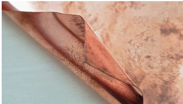
[FIG. 5] Lamiera di rame facilmente modellabile, spessore 0,3 mm.
